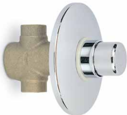
R 737 MAGIC Podomítkový časový ventil pro pisoáry s chromovanou krytkou s výtokovým časem cca 6 sec a automatickou regulací průtoku 7 l/min. Recessed urinal tap, chrome brass plate automatic flow 7 l/min. supplied for about 6 sec.
